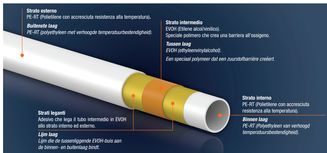
Stratigrafia tubo polipert Polipert pijp strategie
